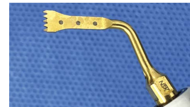
図4-1b ■ ラテラルアプローチに使用するチップの H-SG1。従来法のダイヤモンドバーと比較して、開窓部のマージンを細かく設定でき、ベベルを付与することも可能です。
